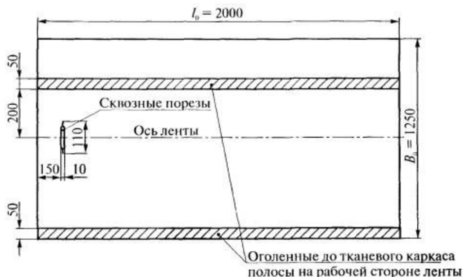
Рис. 3. Схема нанесения искусственных повреждений на образец ленты
